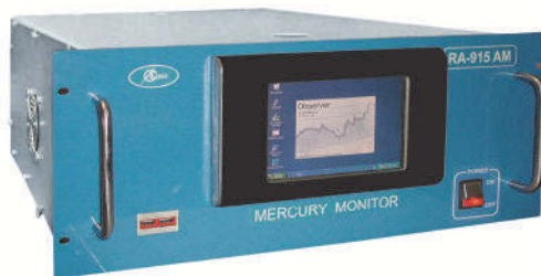
Рис. 2. Автоматический монитор RA-915AM для непрерывного измерения содержания ртути в атмосферном воздухе.
