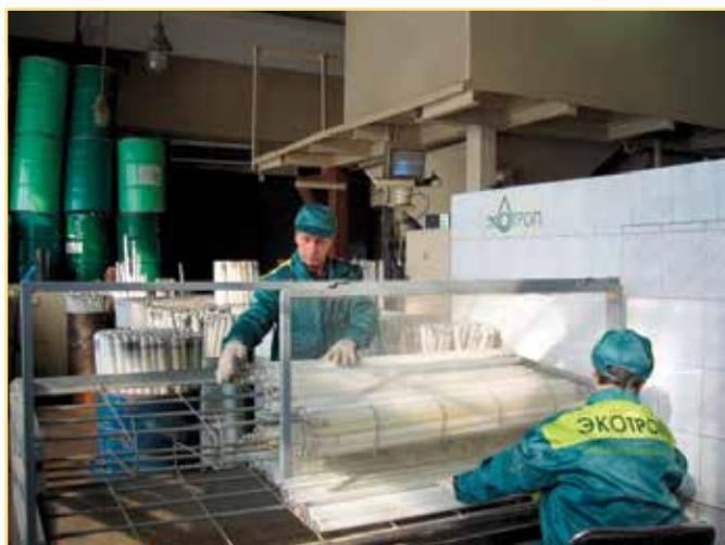
Фото 3. Переработка люминесцентных ламп на установке «Экотром-2»
