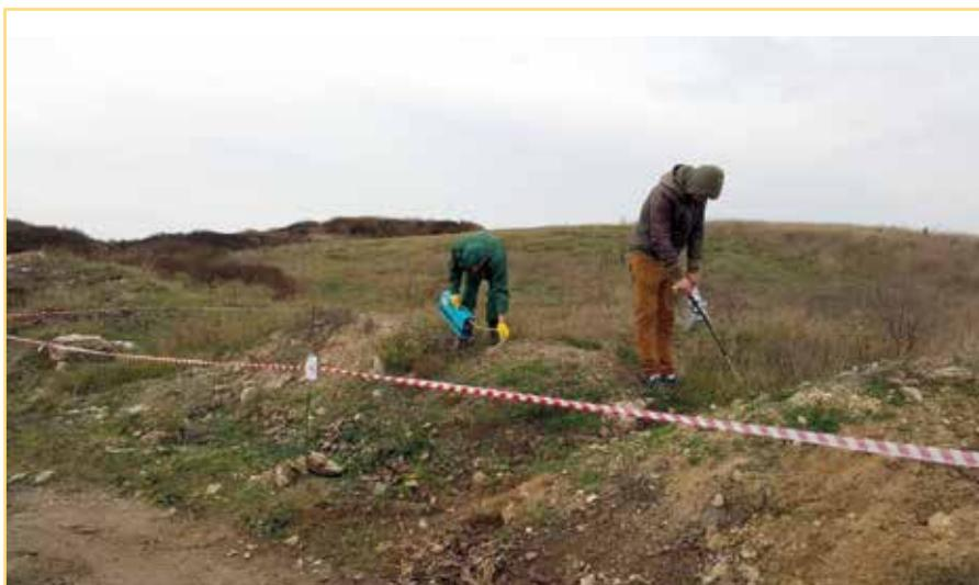
Фото 4. Ртутнометрические измерения на загрязненном участке
