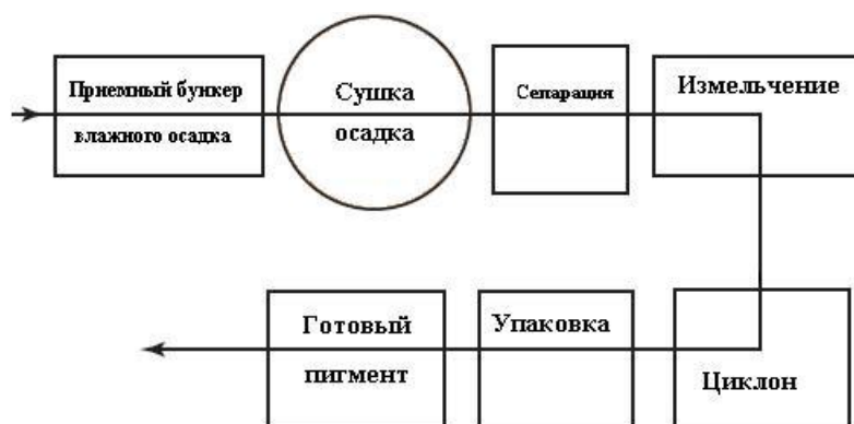
Рис. 7. Принципиальная схема получения сурикоподобных пигментов на основе Fe-содержащего осадка [4].
