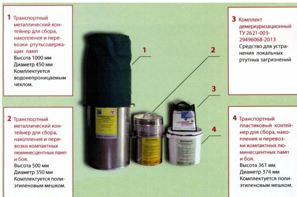
Рис. 2. Комплект специального инвентаря для оснащения рабочих мест сбора и накопления ртутных ламп.
